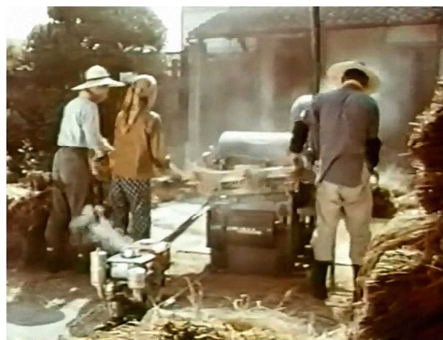
昭和38年頃の石油発動機による脱穀作業
