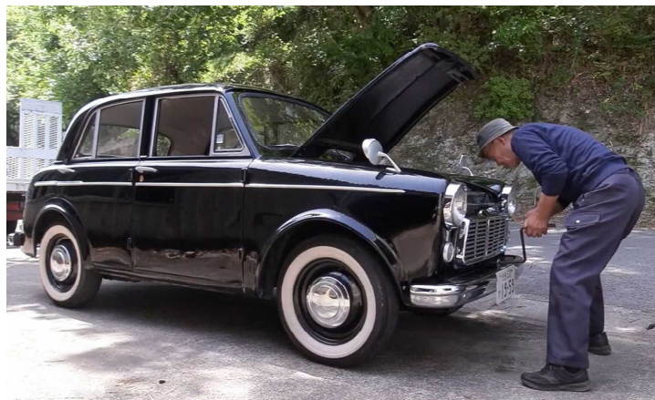
クランク棒によるダットサン211型のエンジン始動
