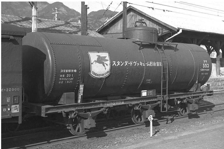
石油輸送用3軸タンク車の例 タサ500形式20トン積タンク車
