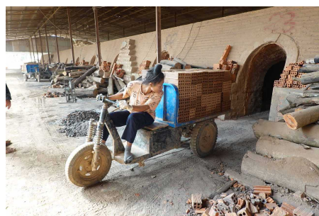
写真5 バイクリヤカーによる煉瓦の窯入れ (2025.1.16筆者撮影)
