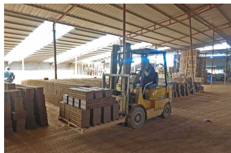
写真3 フォークリフトでの煉瓦運搬と自然乾燥中の煉瓦群 (2025.1.16筆者撮影)
