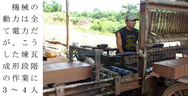
写真12 左から押し出された成形煉瓦の練土をワイヤーカットで切断(2014.8.22筆者撮影)
