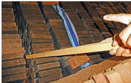
写真20 燃えが悪いときは煉瓦隙間から細めの薪を入れ込むと説明(2014.8.22筆者撮影)
