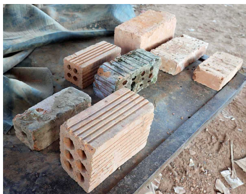
写真13 各種の生産煉瓦(各種穴あき煉瓦のほか、奥右二つが石炭入り「大」「中」煉瓦、奥左が傾斜煉瓦)(2019.12.21筆者撮影)
