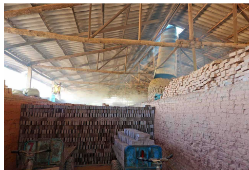
写真7 輪環窯の中央に付け替えられた煙突 (2019.12.21筆者撮影)
