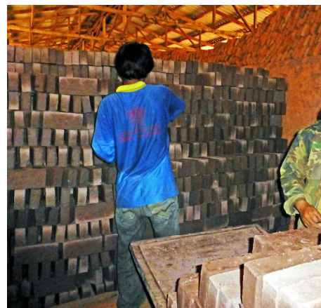
写真15 2人で窯入れ作業、積み方に工夫(2014.8.22筆者撮影)
