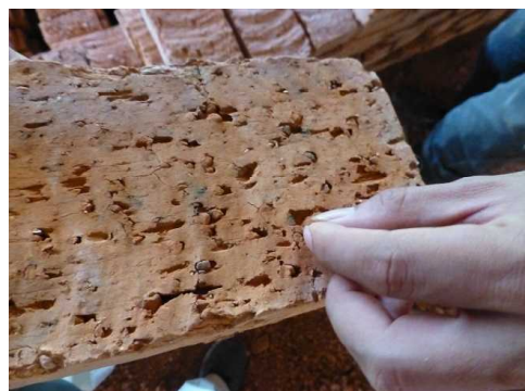
写真8 焼成後の石炭入り煉瓦。石炭殻が取れた穴が目立つ、内部にある焼成後の石炭殻はそのまま残る(2014.8.22筆者撮影)
