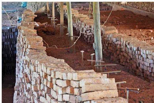
写真19 風洞の上部に何か所にも取り付け風量調整用ダンパーのハンドル(2014.8.22筆者撮影)
