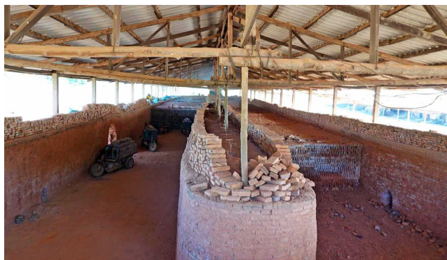
写真3 中国湖南から伝わる輪環窯の窯内全景 (2019.12.21筆者撮影)
