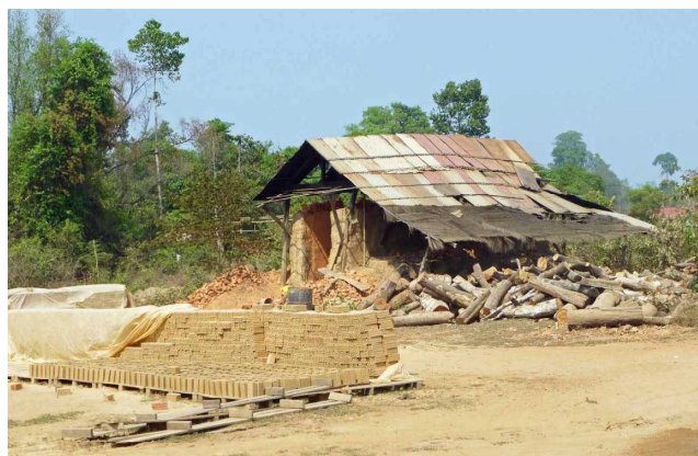
写真2 「ラオス式」煉瓦焼成窯と焼成前の天日乾燥中の煉瓦(2014.3.12筆者撮影)
