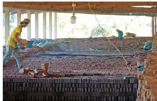
写真17 窯入れ煉瓦の上に煉瓦を全面に敷き詰め、さらに乾いた砂で被う(2019.12.21筆者撮影)
