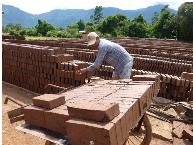
写真14 石炭入り煉瓦の日干し乾燥の作業と乾燥中の煉瓦(2014.8.22筆者撮影)
