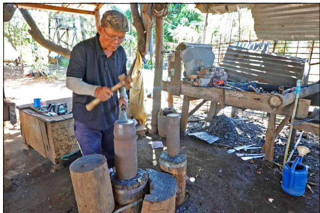
写真5 二つの砲弾を利用した金敷での作業、鍛冶炉の下に量産用と思われる加工中の鉋が並ぶ(2025.1.16筆者撮影)
