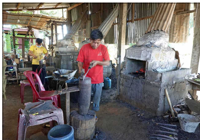
写真1 鍛冶炉を3基設備する18km村の鍛冶屋、奥に機械ハンマーを設備(2025.1.16筆者撮影)
