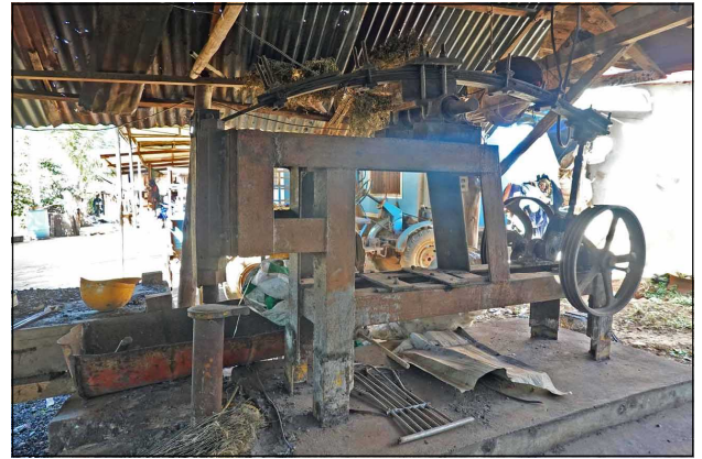
写真3 機械ハンマーを1台設備する19km村の鍛冶屋 (2025.1.16筆者撮影)
