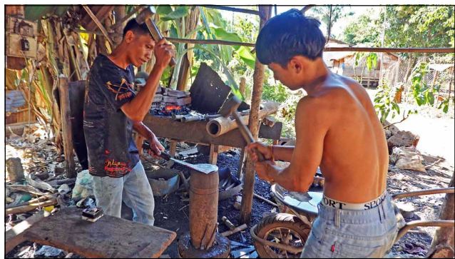
写真4 手打ちによる鉋づくり、金敷に砲弾を利用、簡易な鍛冶炉と鍛冶作業の状況は8年前と不変(2025.1.16筆者撮影)
