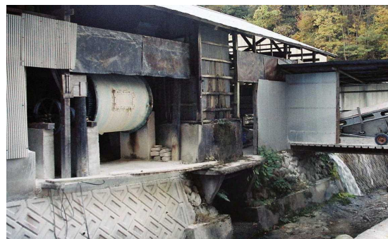
当時稼働中の水車動力のトロンメル (瑞浪市釜土町神徳川沿い、2001.11 筆者撮影)
