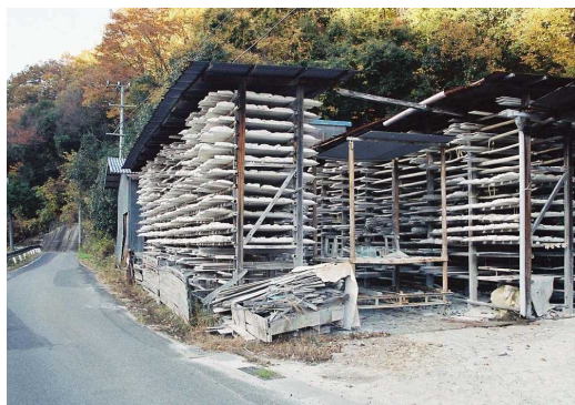
トロンメルで粉碎した陶土の乾燥棚 (瑞浪市釜土町の佐々木川沿い、2001.11 筆者撮影)
