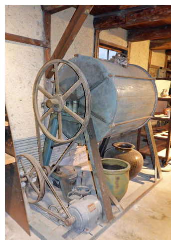
常滑の旧製陶工場に残る電動機付きのトロンメル (常滑市栄町、2023.11 筆者撮影)
