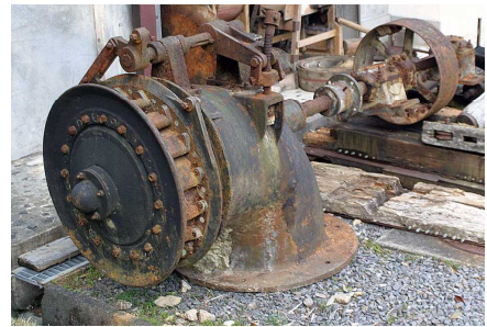
発掘された製材用タービン水車 (新城市、2004.3 筆者撮影)
