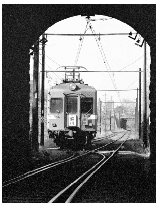
[写真6] ガントレット、上は本町橋
