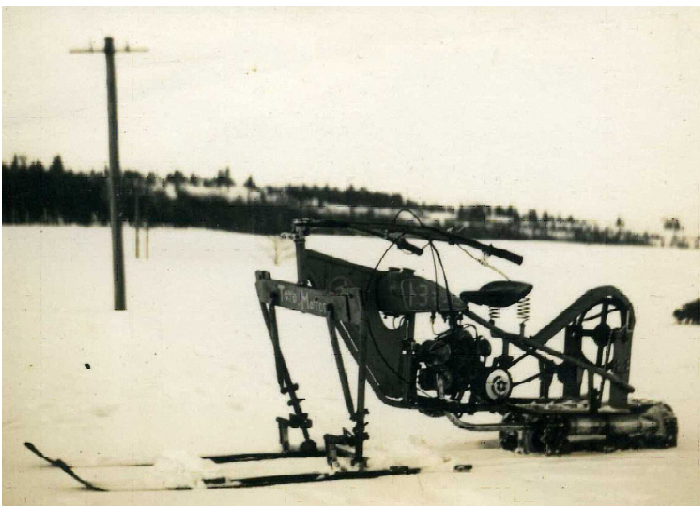
トヨモーター雪上バイク試作車 (1951)
