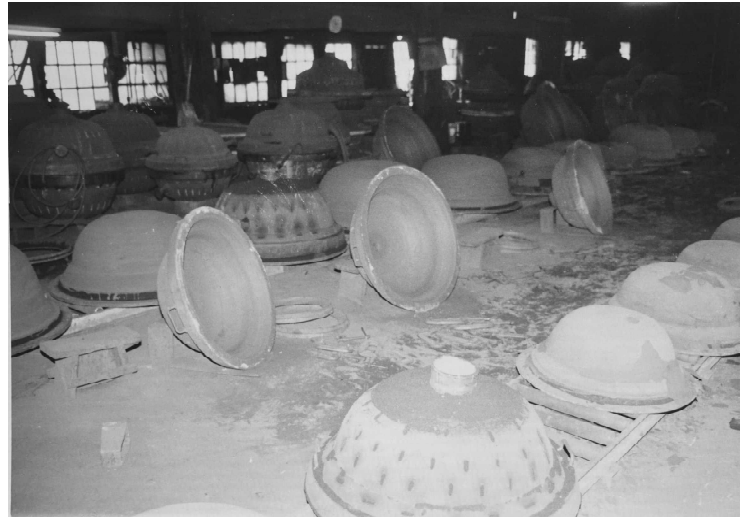
服部工業の鋳造工場における三州釜の鋳造(昭和時代)
