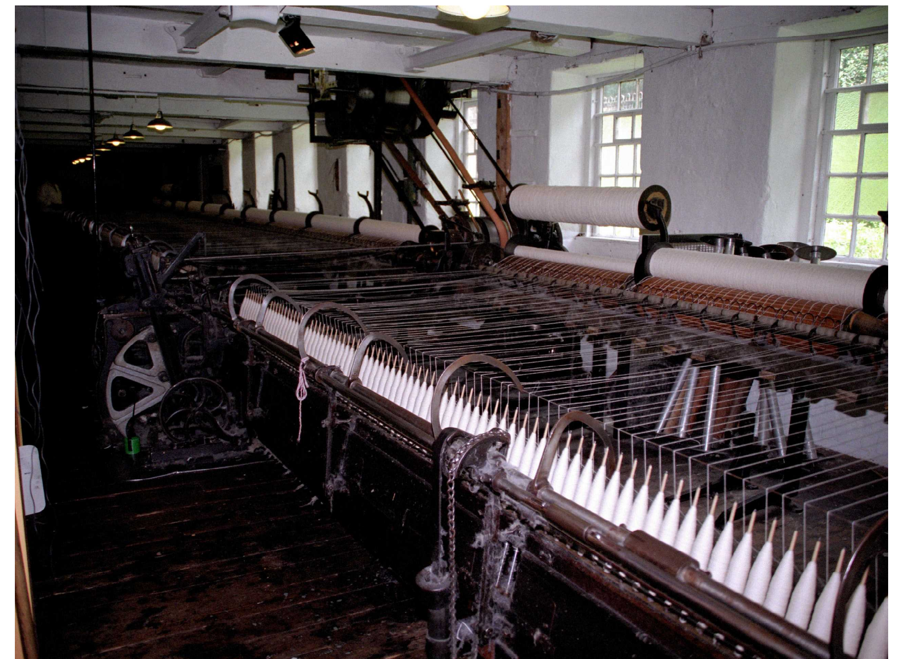
幕末の日本に輸入されたミュール精紡機 (Quarry Bank Mill)
