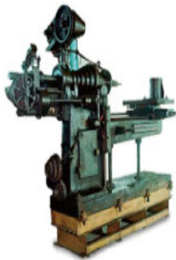
横中ぐり盤 イタリア Ditta Morini & Bossi 社製 (19 世紀後半) 出典: http://machinetool.co.jp/19_10.html
