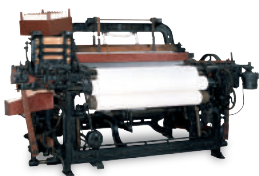
無停止杆換式豊田自動織機（G型）
