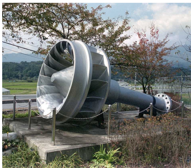
【写真2】南向発電所の発電用水車ランナ (2004/10/24撮影)
