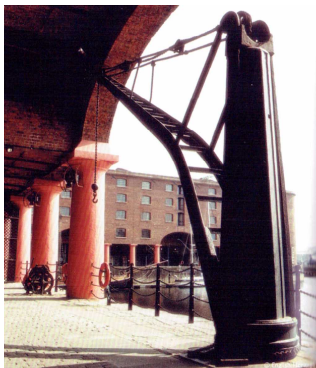
〔写真3〕 アルバート・ドッグの水圧クレーン (出典：Liverpool: World Heritage City, 2014)
