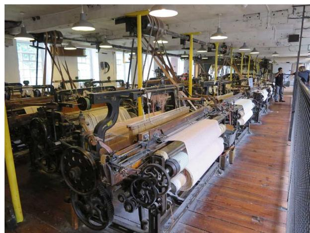
[写真21] 動力織機による織布の実演
