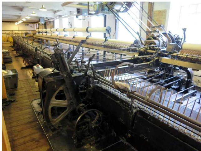
[写真20] 稼働しているミュール精紡機
