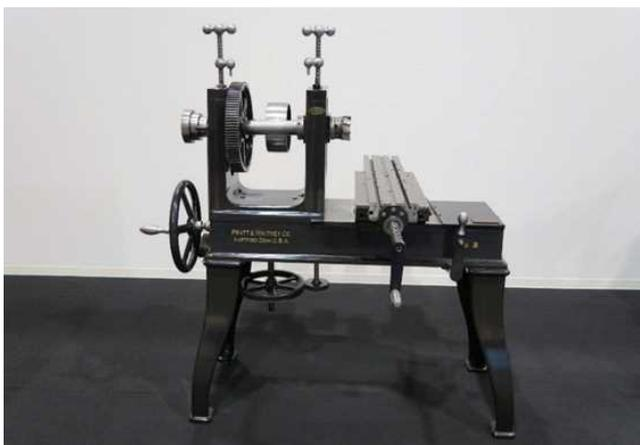
写真4 ベルト掛けリンカーン型フライス盤
