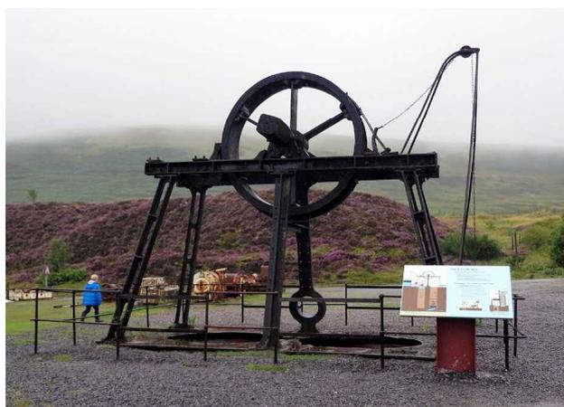
[写真9] 水平平衡昇降機
