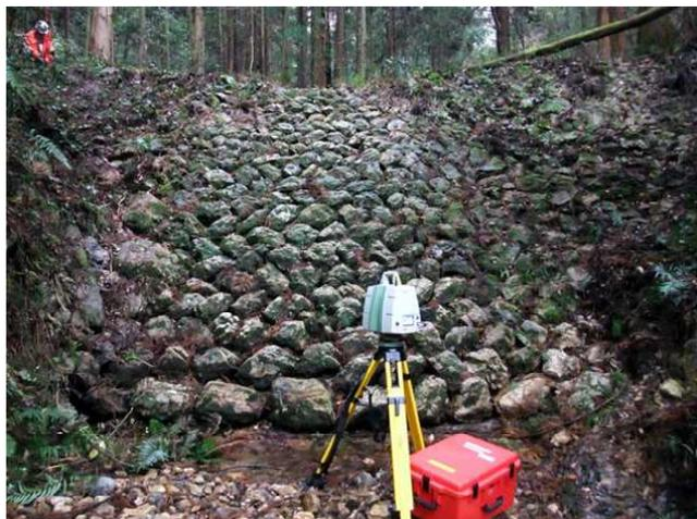
【写真1】 岩舟川支川10の④ 空石積堰堤工と3Dレーザースキャナ
