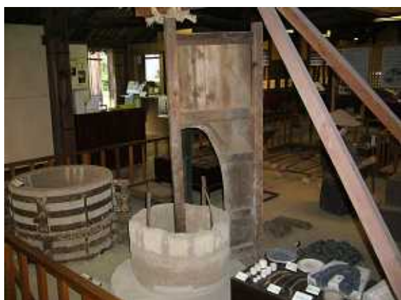
写真5 梵鐘の外型・中子・中子挽型
