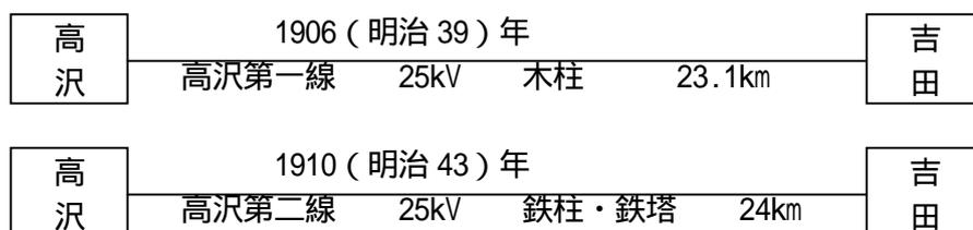
その後、1913（大正2）年に第二線が、また、1920（大正9）年に第一線が、ともに送電電圧を35kVに昇圧している。1958（昭和33）年に至り第一線が撤去された。第二線は高沢吉田線と改称された。その際、吉田変電所から本鉄塔を経て長野電鉄吉田変電所へ送電された。その時点で本鉄塔は「長野電鉄線 NO.12」と称された。従って本鉄塔は、高沢第二線と長野電鉄への送電線を併架した。その状態は、1999（平成11）年に高沢吉田線が撤去されるまで続いた。
