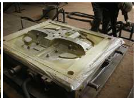
写真7 鋳型 （V - プロセス法）
